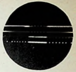
Bild 6. Impulschema der Fernsehnorm (etwa 3% der Bildperiode), wie es auf dem Bildschirm des Grundig-Fernsehoszillografen erscheint
